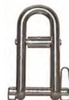
Grillo dritto in acciaio inox AISI 316 con traversino e perno imperdibile a scatto.
