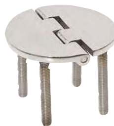
Cerniera lucidata a specchio in acciaio inox AISI 316. Nodo rovesciato, fissaggio con prigionieri
