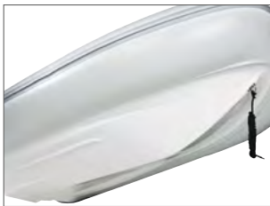
Chiglia in vetroresina a V per una navigazione stabile
